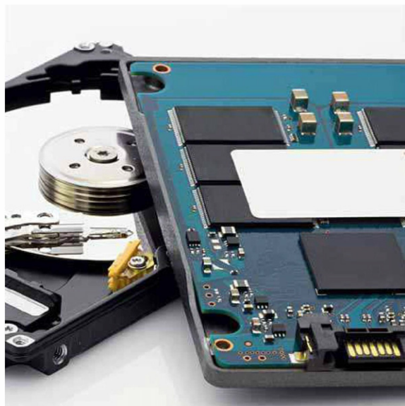
Vlevo je pevný disk, vpravo SSD disk.
